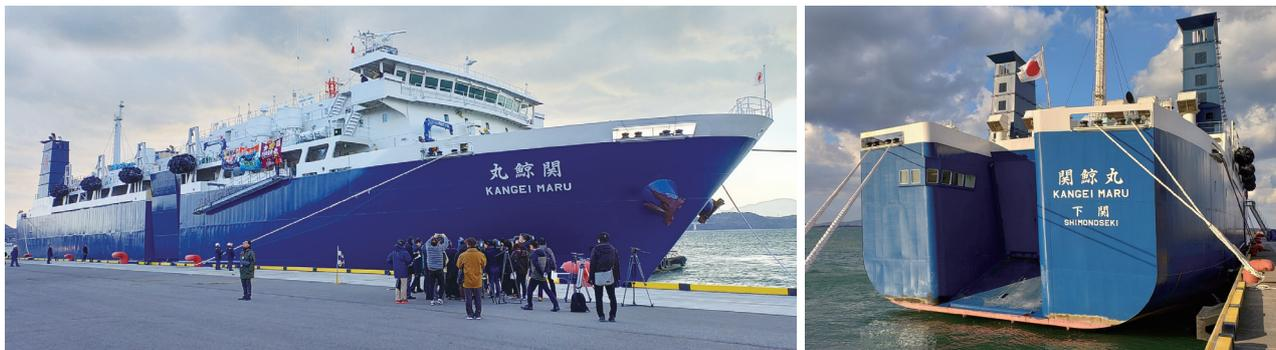
図9. 2024年度より捕鯨母船として就航した関鯨丸。解剖甲板を屋内型としたため、日新丸よりもスリップウェイの角度が緩やかになり大型鯨の揚鯨が容易になった。
