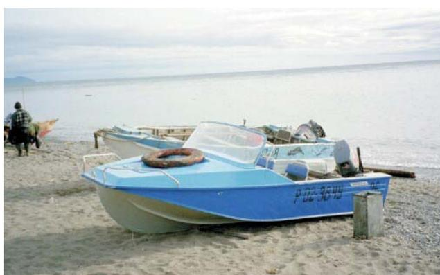
写真 4b：捕鯨に用いられる船（手前はアルミ製、奥は木製）
