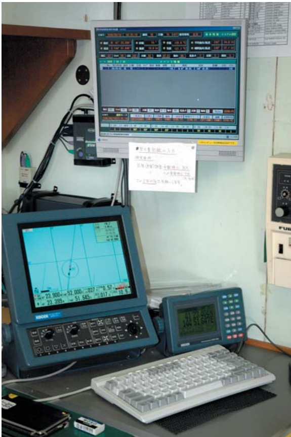
図3．海図室クライアントパソコン(海幸丸)。画面左下は航海用GPSプロッタ装置、その右はGPS受信機。クライアントパソコン本体はGPSプロッタの背後壁面に設置している
