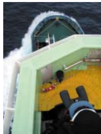
図 2 . ( e ) : 目盛付双眼鏡内のイメージ図。中央の線を水平線に合わせ、鯨群までの距離を読取る。( f ) : 調査船トップパレルの角度推定板。観察者の正面に設置されている。上は船首部分。
