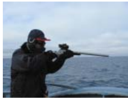
図 3 . ( a ) : 当研究所が開発したバイオプシー空気銃 ( ナイロンロープをつけたダーツによりサンプルをすばやく回収できる )、( b ) : デンマークが開発したラーセンガン ( ダーツ回収作業に時間がかかるが飛距離と命中率は向上した )、当日の海況や鯨種、性質等を考慮して機器を選択する。
