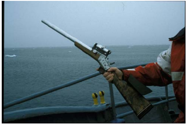
(写真2) バイオプシー試料採集のために使用するラーセン銃 (上:機材一式、下:組み立て後)
