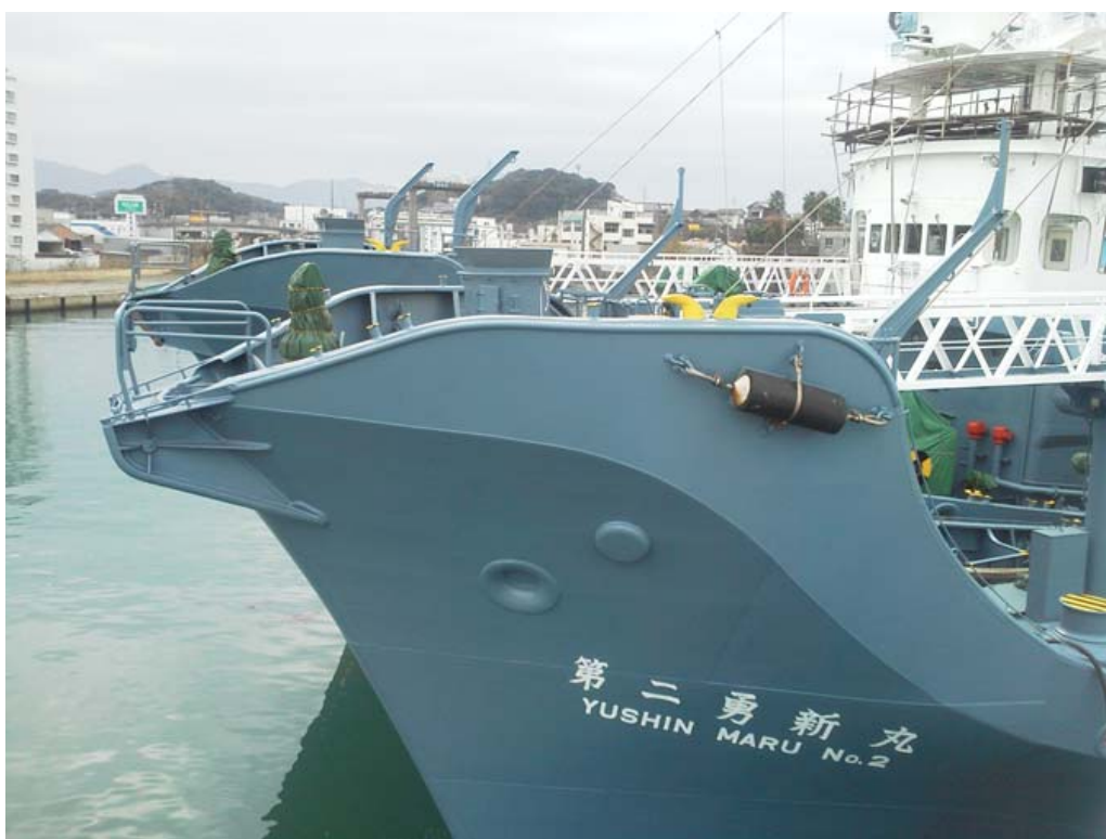
(写真1) 捕鯨砲を取り外した目視調査船勇新丸(上図)と第二勇新丸(下図)
